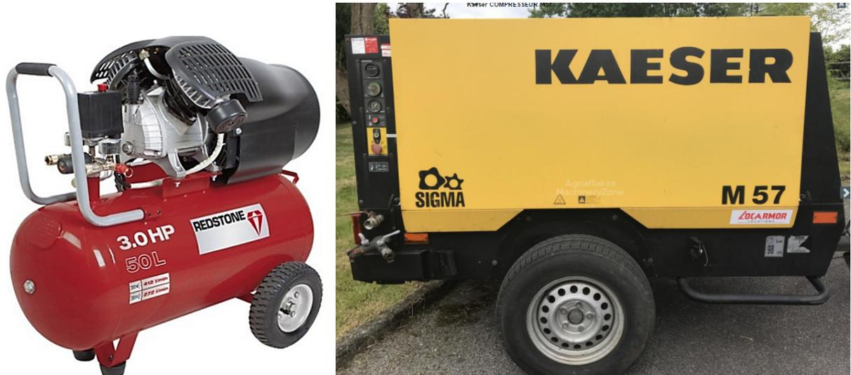
Figure.12. Compresseurs pour chantiers.
