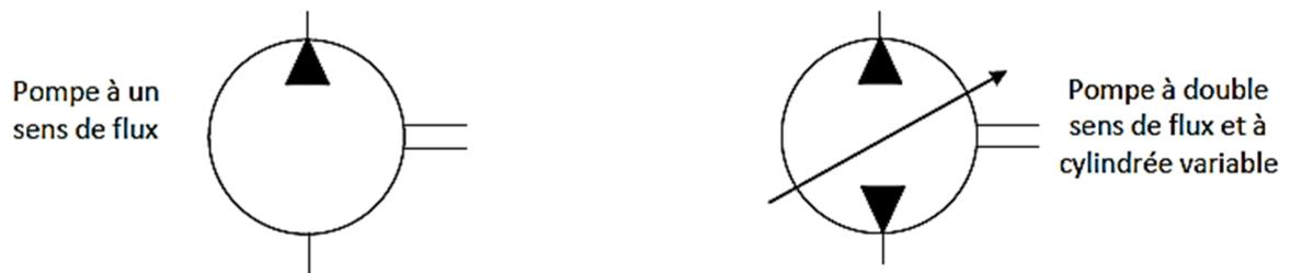
Figure.9. représentation schématique d'une pompe.
